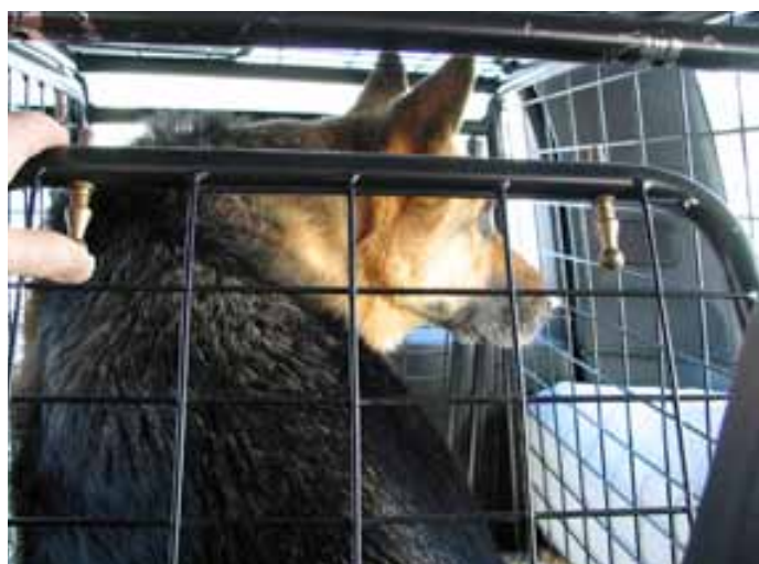
Evakueringslucka framåt underlättar om bilen skulle bli påkörd bakifrån och luckan inte går att öppna.
